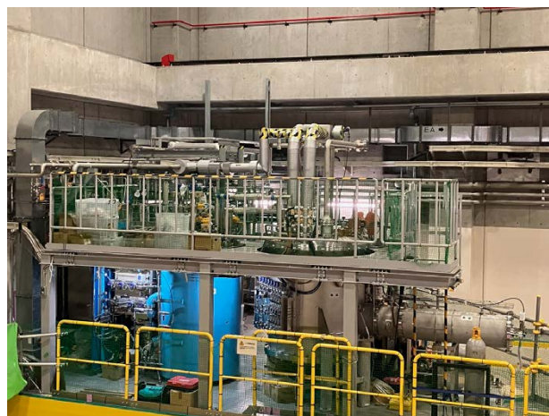
図 1. COMET 超伝導磁石用冷凍機システム
