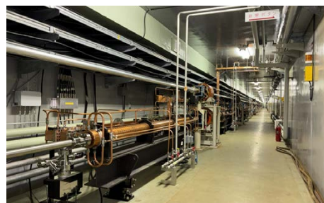
SKEKB-BT 7 GeV 電子ビーム用 ECS 加速管
