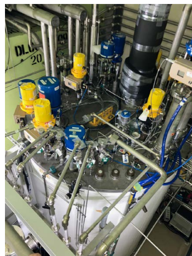
図 2. ミュオン D ライン超伝導磁石用冷凍機システム
