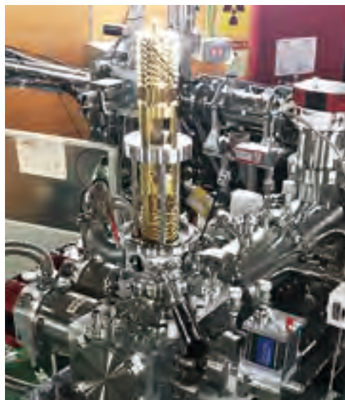
MRTOF質量分光器内部構造。短寿命核の質量測定ばかりでなく、環境汚染物質の分析への応用も可能です。
