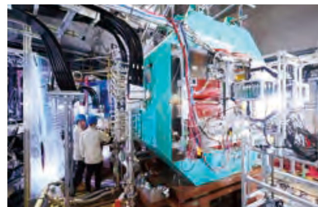
K1.8 ビームラインに設置された S-2S スペクトロメータ
