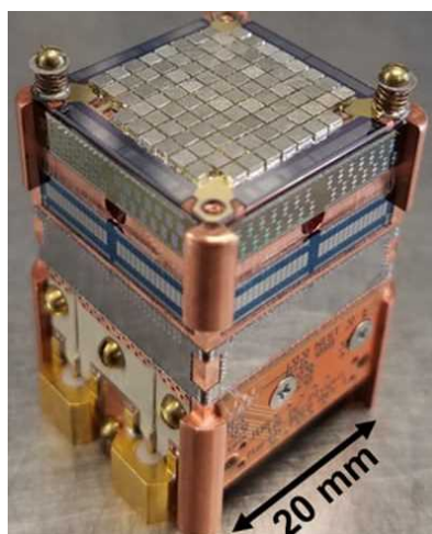
高エネルギー X 線対応 TES (NIST 制作プロトタイプ)
