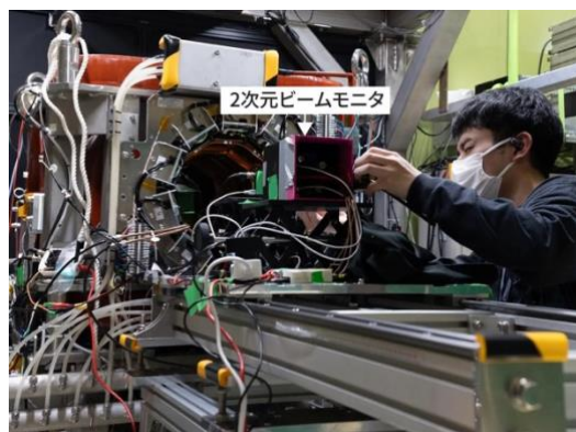
自作の2次元ビームモニタをビームライン上に設置
