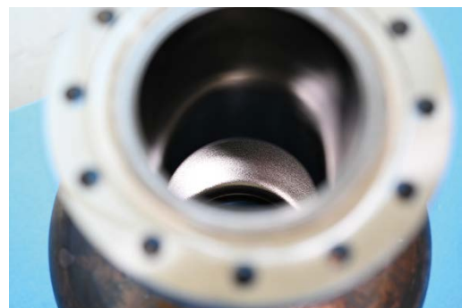
図 2. ニオブコーティングした空洞の内面
