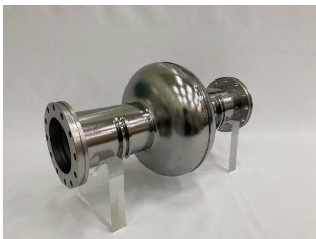
図 1. Nb 製単セル超伝導加速空洞
