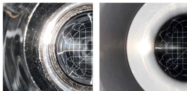
図 2. Nb 3 Sn 成膜前後の空洞内面の様子。左：成膜前 (Nb 表面)、右：成膜後 (Nb 3 Sn 表面)
