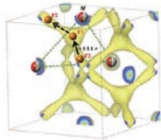
丈夫で長持ちな次世代電池として期待される全固体電池。その有力候補フッ化物イオン伝導体の中で、原子がどう並び、イオンがどう流れるかを中性子回折実験で捉えます。未来の電池へのヒントにつながります。
