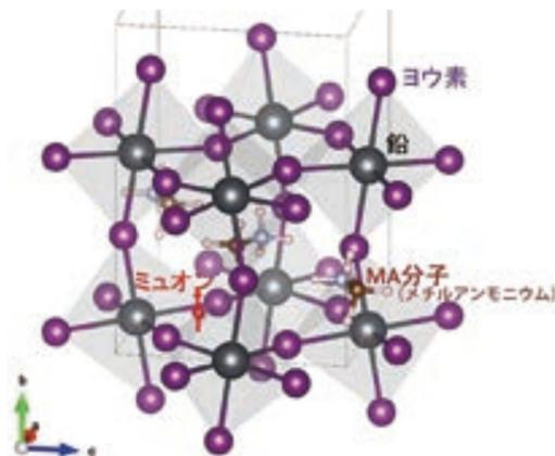
ヨウ化鉛メチルアンモニウムは、将来の太陽電池として有望な物質です。この物質では、鉛とヨウ素でできたジャングルジムのような構造の中でメチルアンモニウム分子が回転しています。その回転の様子をミュオンで観測し、メチルアンモニウム分子のちょうどよい回転運動が太陽光を電気に変える効率の向上につながることをつぎとめました。
