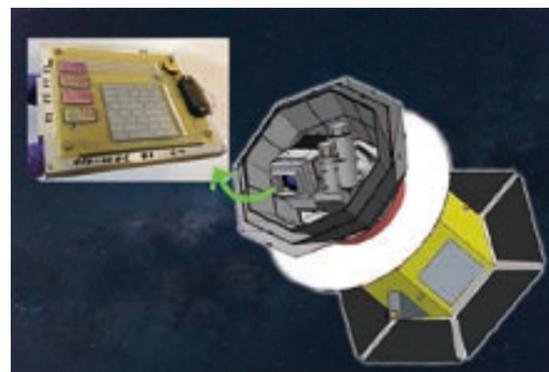
誕生直後、宇宙はインフレーションと呼ばれる急激な膨張をしたと言われています。この時期の情報は、ほとんどが過ぎて起きたビッグバンにかき消されてしまっています。しかし、ビッグバンの38万年後に放出された宇宙背景放射(CMB)のわずかな偏光に、当時の痕跡が残されている可能性があります。LiteBIRD衛星は、CMBの偏光を観測するために、QUPの羽澄昌史拠点長が提案した衛星観測計画で、JAXAのロケットで打ち上げられる予定です。QUPでは、CMBを観測するための高精度センサー・超伝導転写端検出器( TES)を開発しています。
