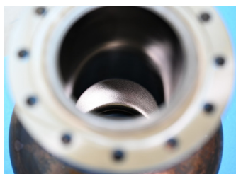
ニオブコーティングした空洞の内面 銀色に輝くニオブ層が見える
