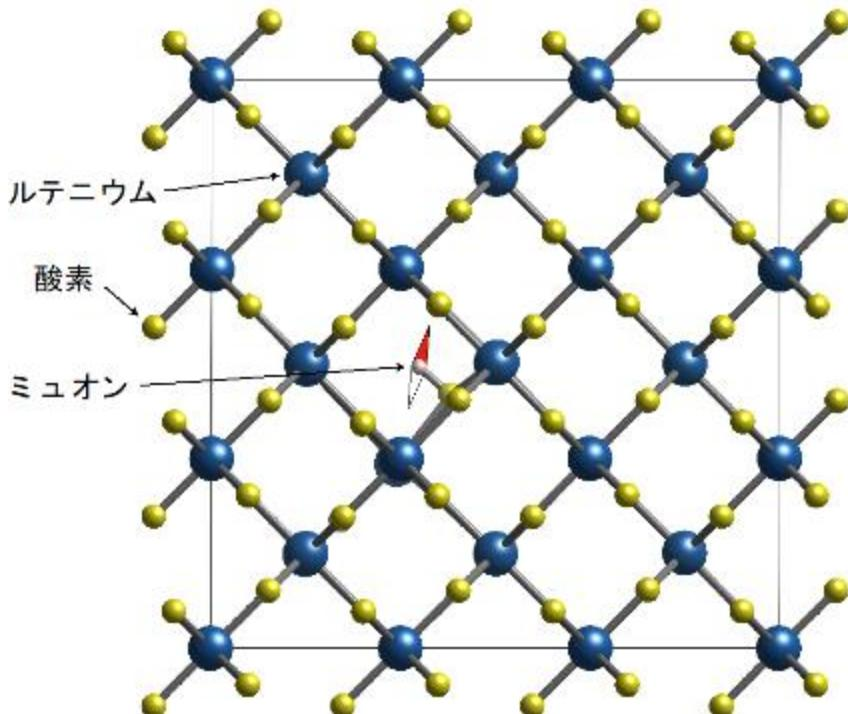
図4 第一原理計算で得られた酸化ルテニウム中のミュオンの最安定構造。黄色で示した酸素とおよそ0.1 nmの結合を作つて安定化することが分かりました。ミュオンがこの場所に止まっていて、報告されている磁気秩序が存在する場合のμSR信号のシミュレーションが図3の左図です
