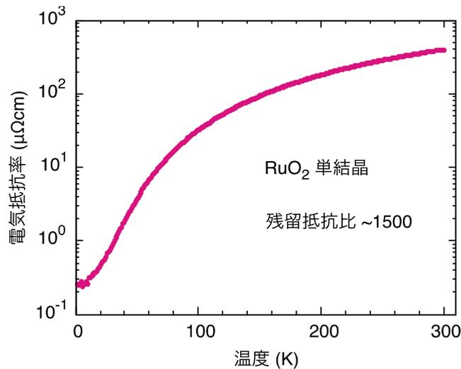
図2 本研究で用いた RuO<sub>2</sub> 試料の電気抵抗率の温度依存性
