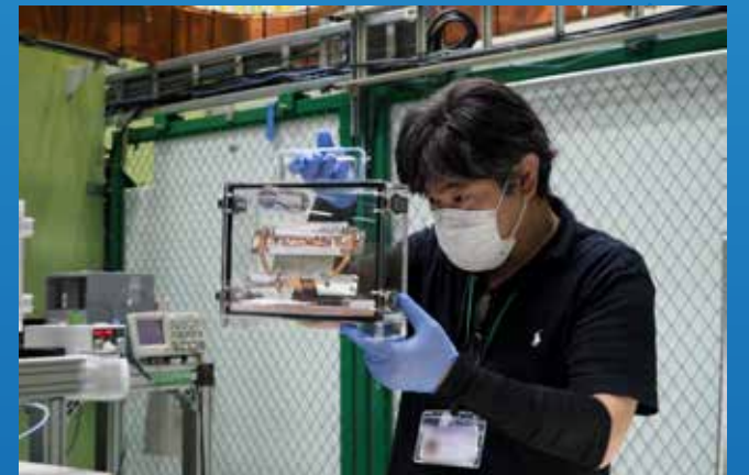
はやぶさ2初期分析「石の物質分析チーム」リーダー 東北大学理学部（地学） 中村智樹教授 実験装置への設置前に試料ケース内を確認しているところ 試料は銅箔に包まれたまま分析される
