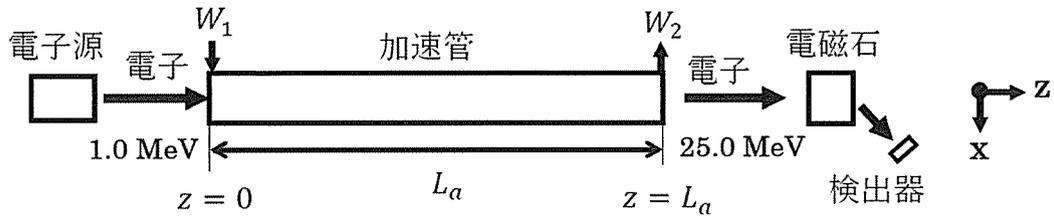
図1：小型の電子加速器の全体図
