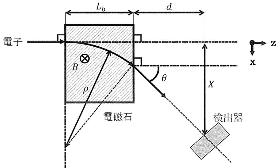
図2：加速管下流にある電磁石と検出器の付近の拡大図
