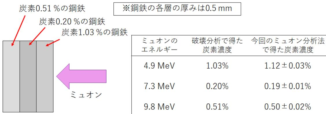
図5 積層鋼鉄試料へのミュオンによる非破壊深さ選択分析実験の概要と結果
