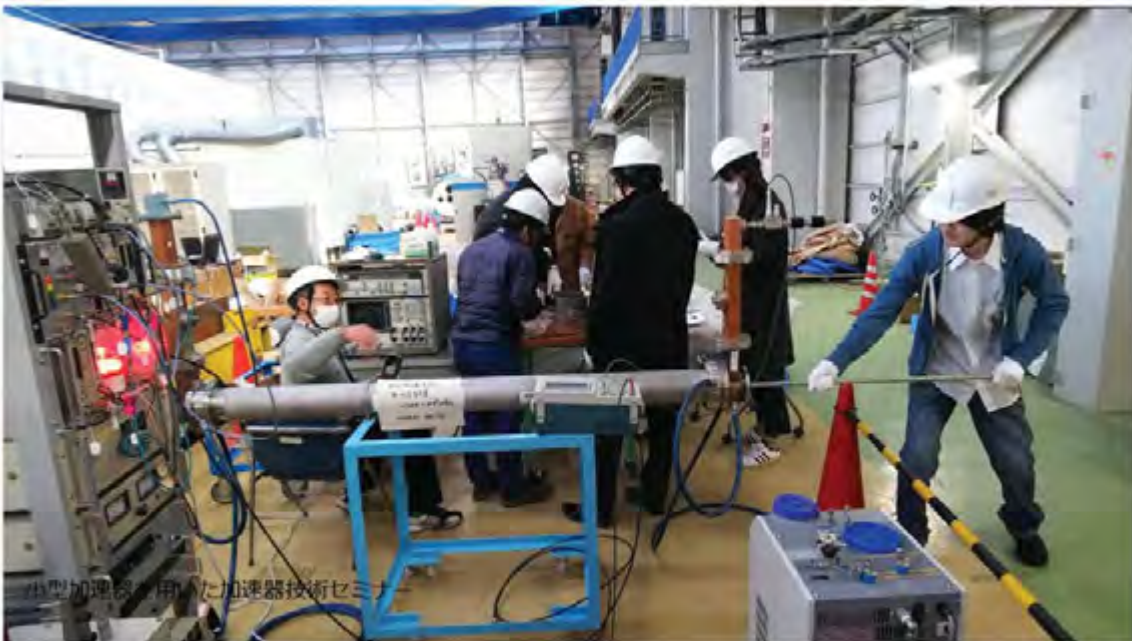
全国の大学、企業を対象とし、小型加速器の製作・運転を骨子とした教育プログラムを2016年度より立ち上げた。第一段階として10kWのクライストロンと2mの加速管を有する基本型の小型加速器を試作、実用を行っている。今後、装置のさらなるスペックアップを回り発展的なプログラムを構築して行く。
