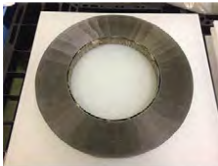
KEKの磁場中熱処理装置でつくられたPSB用金属磁性体リング
