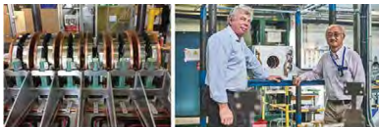
CERNで組み立て中のPSB空洞
