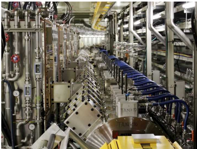
メインリング直線部の高周波加速空洞
