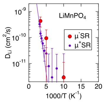
図 2  $\mu^+$ SR で求めた Li の拡散係数( $D_{Li}$ )と絶対温度の逆数の関係。 $\mu^-$ SR の結果から Li の拡散が証明され、 $\mu^+$ SR の結果から  $D_{Li}$ の詳細な温度依存性を求めた。
