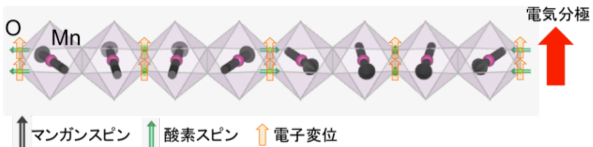
図1： \text{YMn}_2\text{O}_5 の、らせん配列するマンガンイオンスピン、理論的に予想されている酸素サイトの電子変位、本研究で観測された酸素イオンのスピン偏極の模式図
