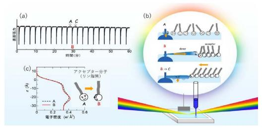
図 1 (a) 表面張力の自発振動 (b) 水面深さ方向の電子密度分布。状態Bは状態Aよりも密度の濃淡がはつきりしており、分子が直立していることがわかる (X線は見えませんが、X線の波長の違いを擬似的に色として表現しました) (c)実験装置と水面の分子の運動
