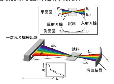
図2 多波長分散型 X 線反射率測定システムの原理図 (News@KEK 虹の X 線で見る「表面」 ~ 高速の X 線反射率測定法 ~ より)
