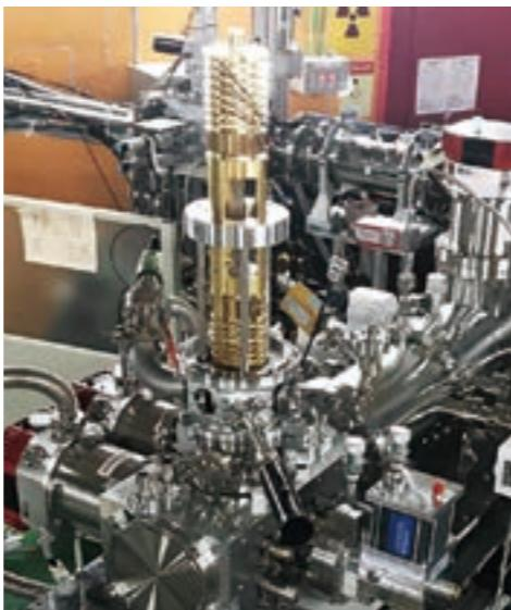
MRTOF質量分光器内部構造。短寿命核の質量測定ばかりではなく、環境汚染物質の分析への応用も可能です。
