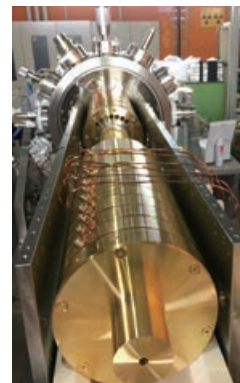
KISS 装置の心臓部 MRTOF 質量分光器内部構造
