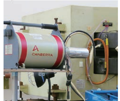
加速器放射化の測定
