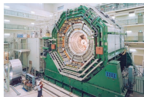
トリスタン加速器を使った実験の測定器のひとつ、トパーズ測定器
