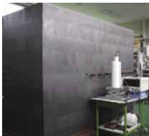
検出器の校正・開発に用いられる黒鉛パイル
