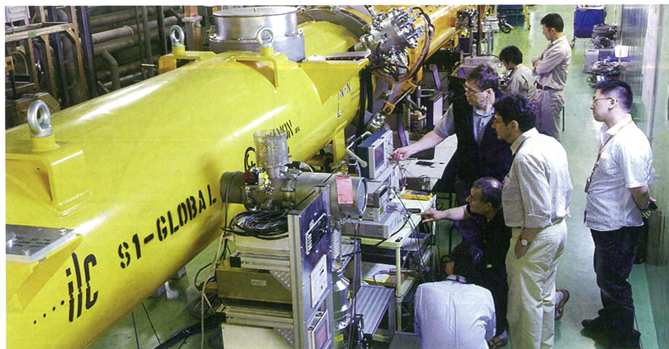
国際協力で行われた技術開発試験「S-1グローバル」のクライオモジュール。KEKの超伝導リニアック試験施設が拠点となっていた
