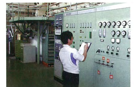
液体ヘリウムを製造、KEK内に供給しているヘリウム液化機
