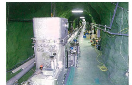
神岡に設置されている重力波望遠鏡のプロトタイプ (CLIO)。鏡を冷やす冷凍機システム (写真、手前) に技術貢献しています
