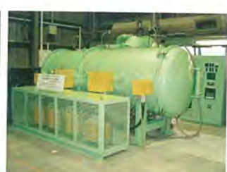
超伝導空洞用 3m 真空炉
