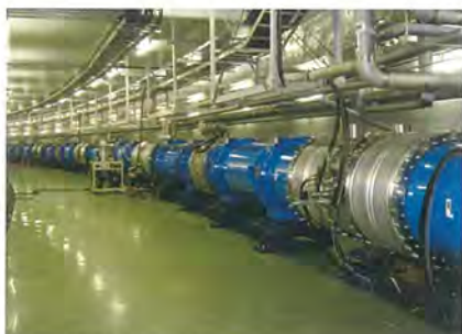
J-PARC ニュートリノ実験・一次ビームラインに設置された超伝導磁石システム。一次陽子ビームを二次粒子発生用ターゲットに導き、ニュートリノを神岡実験施設にむけて送りだします。
