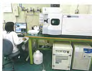
ICP 発光分光分析装置を用いて、溶液試料中の微量元素の定量分析を行う。
