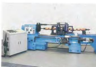
特殊加工機及び加工法の開発研究 「超伝導シームレス空洞のしぼり加工機」
