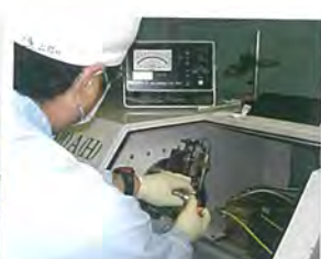
超精密加工による常伝導 X バンド加速管用ディスクのサブミクロン芯出し作業
