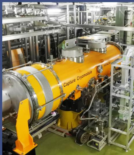
KEKの超伝導リニアック試験施設 (STF) のクライオモジュール
