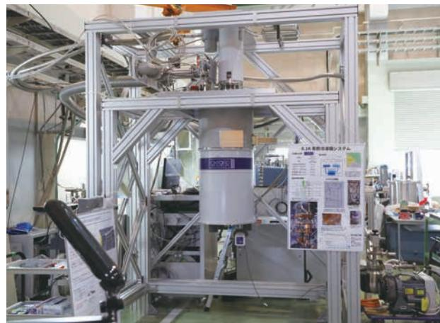
先端計測実験棟に設置された希釈冷凍機システム
