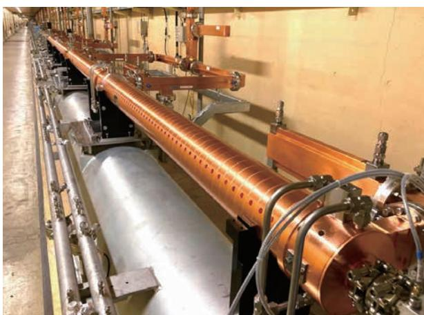
電子陽電子リニアックの新しい加速管（つくばキャンパス）
