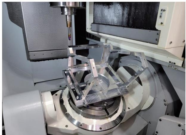
機械工学センターで製作した LiteBIRD 低周波望遠鏡用ミラーの 1/4 スケールモデルのフレーム
