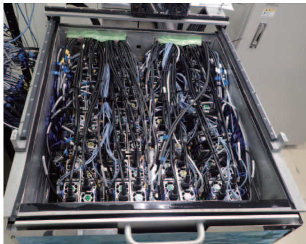
図 4. 液浸冷却システムを有する Suiren Blue
