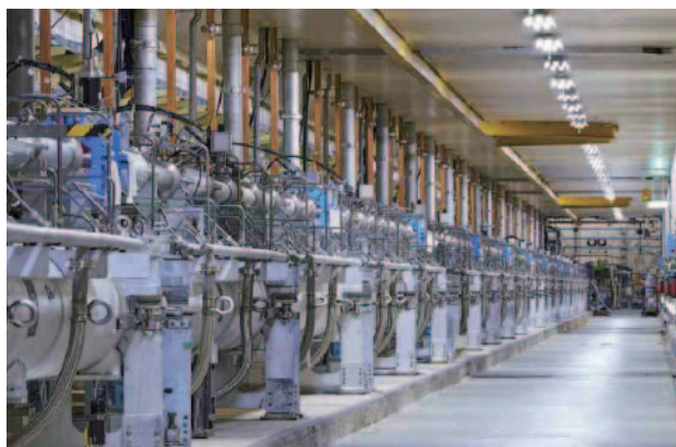
電子・陽電子線形加速器に設置されたパルス電磁石 (写真中の青色磁石) (つくばキャンパス)
