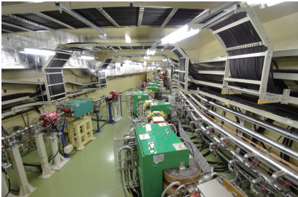
完成した SuperKEKB 陽電子ダンピングリング (右) とビーム輸送路 (左) (つくばキャンパス)
