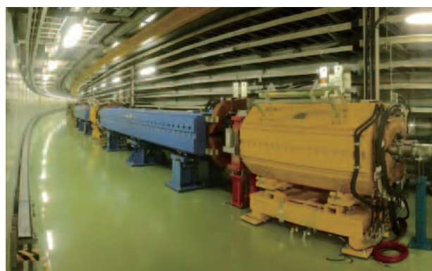
図 2. MR トンネル内での偏向電磁石 (青色) と収束磁石 (黄色)。偏向電磁石でビームを曲げ、収束磁石でビームを収束させる。
