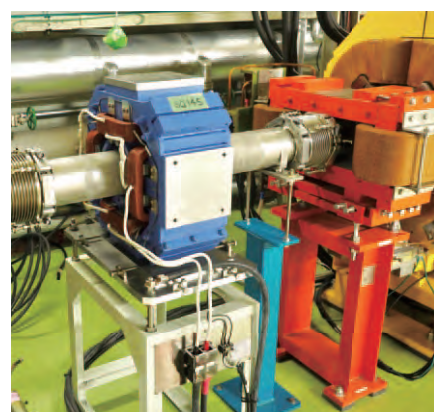
図5. スキュー四極電磁石(青色)と補正偏向電磁石(橙色)
