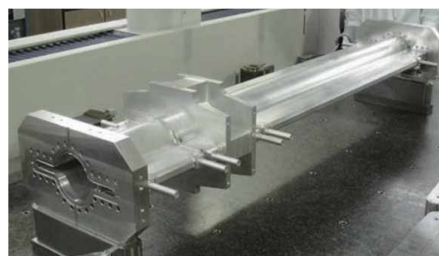
図 3：アンテチェンバー型ビームパイプ ビームパイプ両側につば状のスリット構造を持つ。ビームからの放射光はこのスリットに沿って、ビームから離れた場所まで引き出される。
