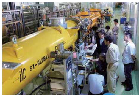
図11：STF 国際協力によるクライオモジュールの組み立て・性能実証試験中の様子。
