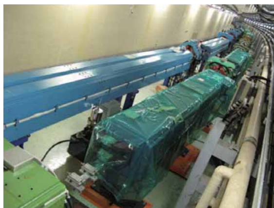
図 1: 陽電子リング (2 本のリングのうち右側) に新たに設置した偏向電磁石
