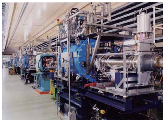
図 6：KEKB 超伝導加速空洞 高い加速電圧で大電流ビームを安定に加速する。
