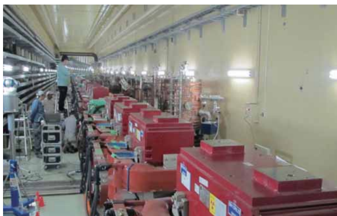
図 2: 電子リングに新設したウィグラー電磁石 壁奥側に見えるのは ARES 型加速空洞
