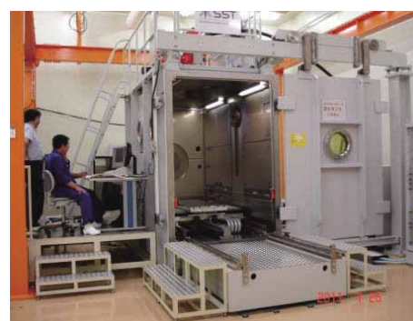
空洞製造技術開発施設内に 設置された電子ビーム溶接機
