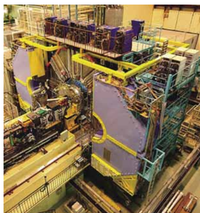
KEKB 加速器で実験が行われた Belle 検出器 (左) とその模式図 (右)
