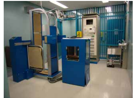
J-PARCの加速器室の出入口にある測定器（持ち出す機器の放射能と人の手足の汚染を同時に測る。）
