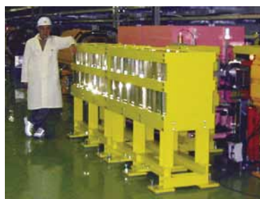
図 1. 鉛ガラスを再利用したシールド
