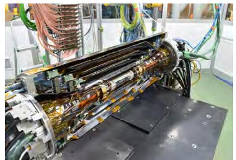
Phase3 運転に向けて設置された崩壊点検出器
