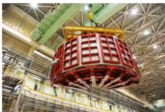
J-PARCの物質・生命科学実験施設MLFに設置された中性子ビームラインBL12へ搬入される高分解能チョッパー分光器の大型真空槽。
