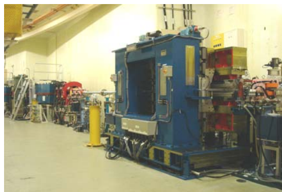
放射光源リングの性能向上のために設置された挿入光源
