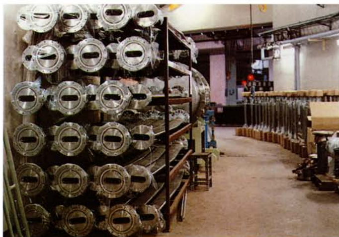
主リング用真空ダクト Vacuum ducts for the Main Ring.
