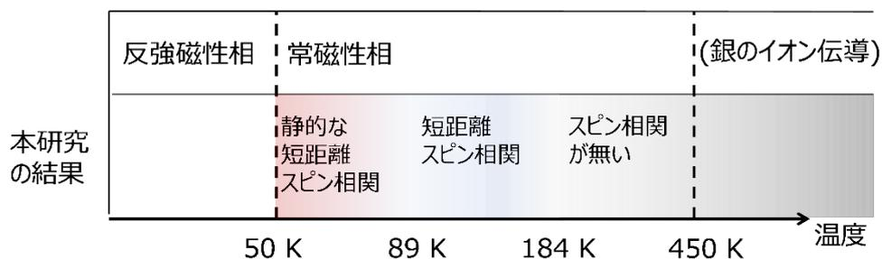
図 1：本研究で示された  $\text{AgCrSe}_2$  の 3 つの温度領域
